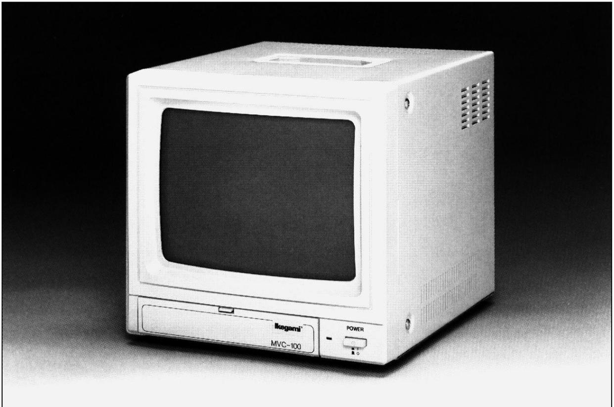
Видеомонитор цветного изображения MVC-100 специально предназначен для работы с телекамерами цветного изображения, телевизионными тюнерами, телевизионными игровыми приставками и другим совместимым оборудованием. Этот видеомонитор с кинескопом Black Matrix со щелевой маской обеспечивает качественное изображение с широкой гаммой цветов. Видеовход для композитного сигнала 1Вп-п/75Ом.
