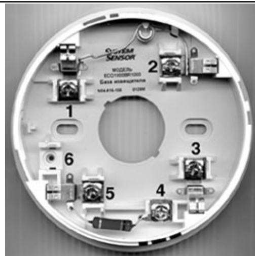
Рис. 1. Расположение контактов базы E1000R
