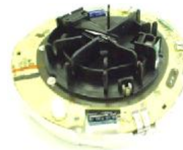
Рис. 15. Дымовая камера лазерного извещателя 7251E "Pinnacle"
